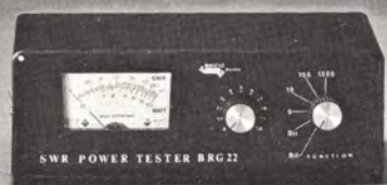
Rosmetro Wattmetro BRG-22
